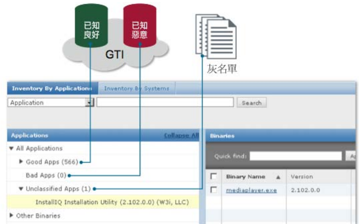
圖 3. McAfee Global Threat Intelligence 會持續監控檔案與寄件者的信用評價，因此能自動封鎖已知的惡意檔案，以及將信用評價不詳的檔案列入灰名單。
